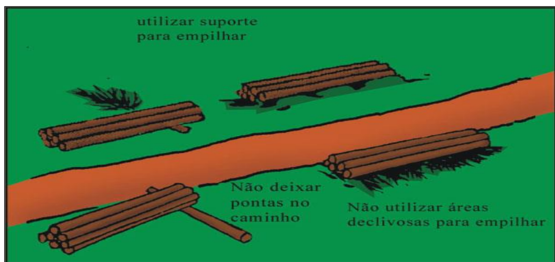
Figura 8-4 - Empilhamento de toras de madeira.
