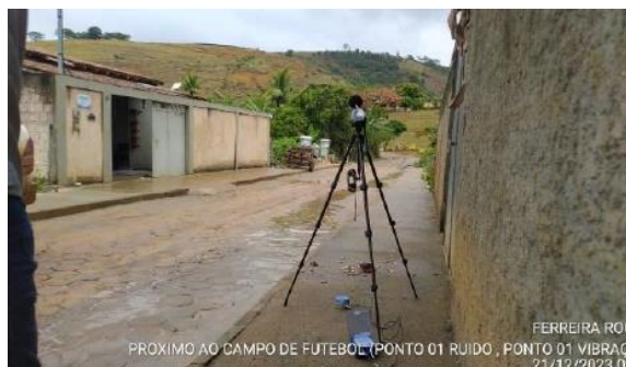
Figura 3-24: Monitoramento de vibração no Ponto 01.
