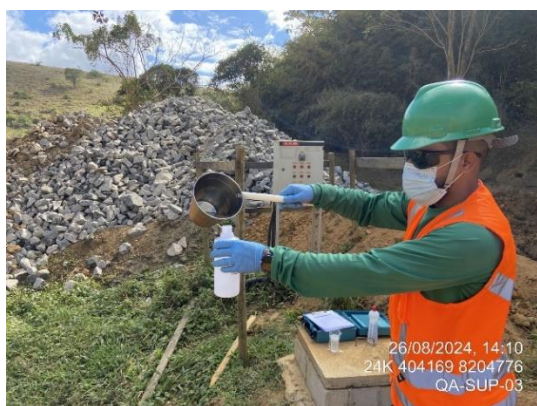
Coleta de água subterrânea em poço.
