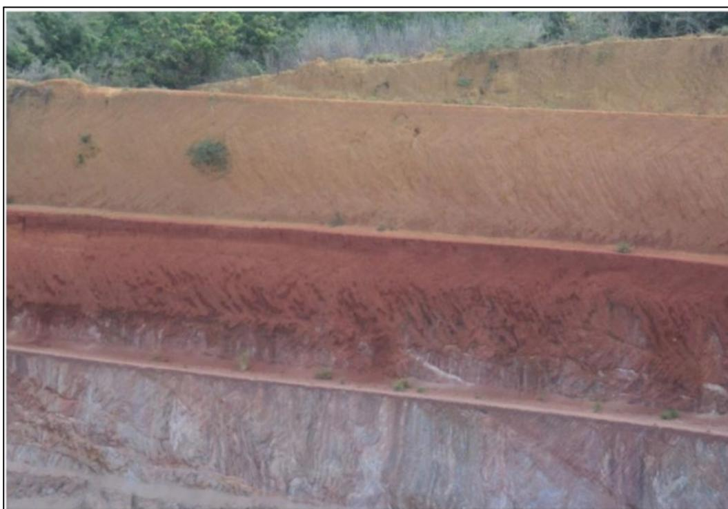
**Figura 31:** Foto da Mina Faz. Califórnia (Nacional de Grafite) em Salto da Divisa (MG): cava mostrando o horizonte silto-argiloso amarelado (aloterita), o horizonte argiloso avermelhado (isalterita) e o gnaisse grafitoso intemperizado (minério). Para nível de escala, cada bancada possui aproximadamente 5 metros de altura.
