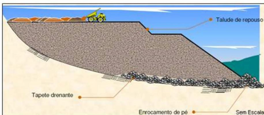
Figura 15: Esquema do Depósito Controlado de Estéril
