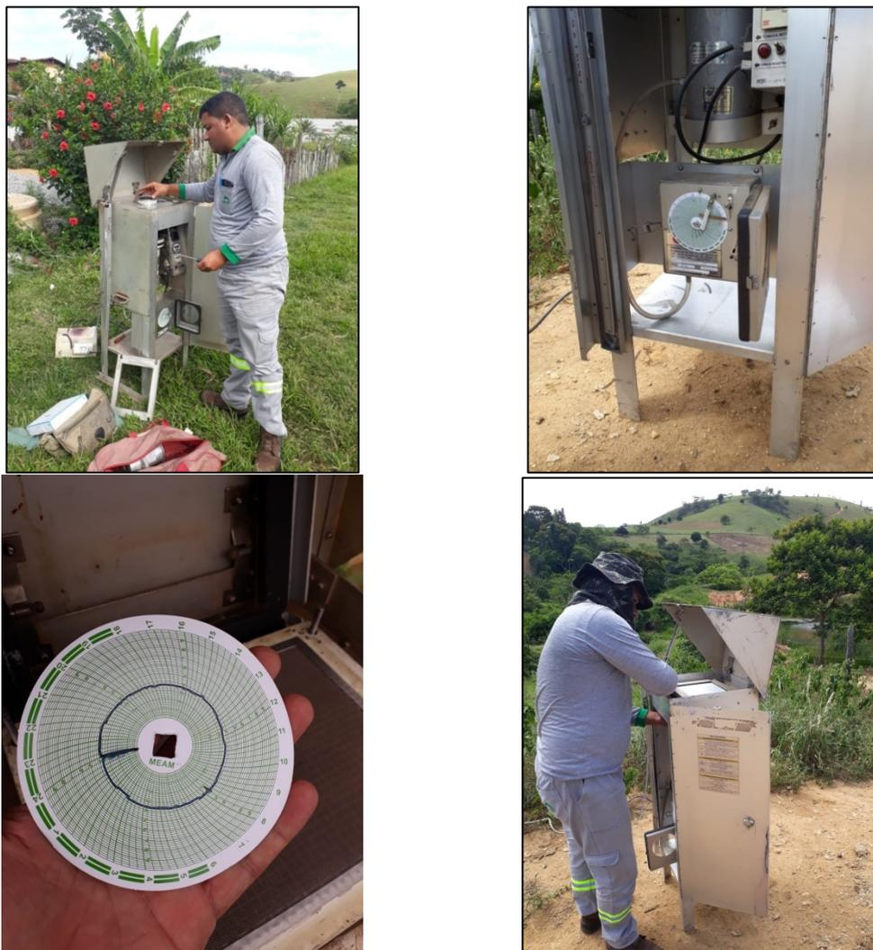
Figura 68: Equipamento Utilização para monitoramento – HI-VOL - CCPTS 010-20
